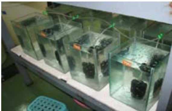
Hình 1. Bố trí thí nghiệm trong các bể thủy tinh có cục lọc sinh học (bio - filter)
