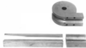
Hình 3. Các chi tiết của bộ phận uốn
