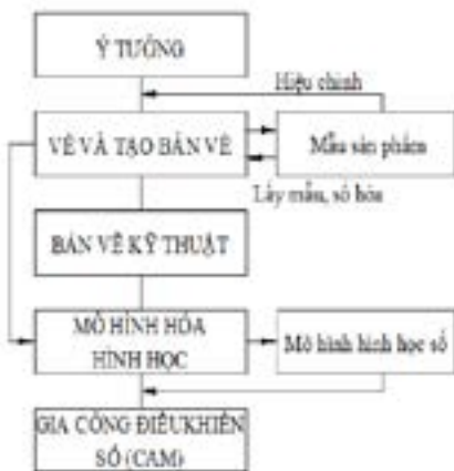
Hình 2. Qui trình thiết kế và gia công tạo hình theo công nghệ CAD/CAM
