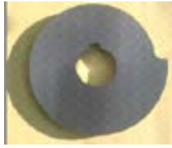
Hình 6. Cam sau gia công trên máy CNC
