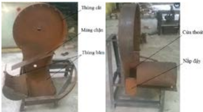
Hình 6. Vị trí lắp thùng cắt và thùng băm
