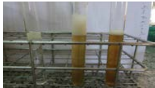
Hình 3.2. Định tính saponin quả thể nấm linh chi Nhật a. Nước cất; b. dịch chiết bột nấm thêm NaOH; c. dịch chiết bột nấm thêm HCl
