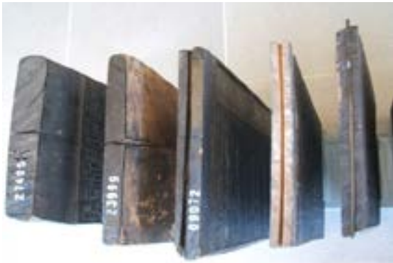
Mộc bản không có thanh nôm bị nứt nhiều hơn so với tấm có thanh tre nôm
