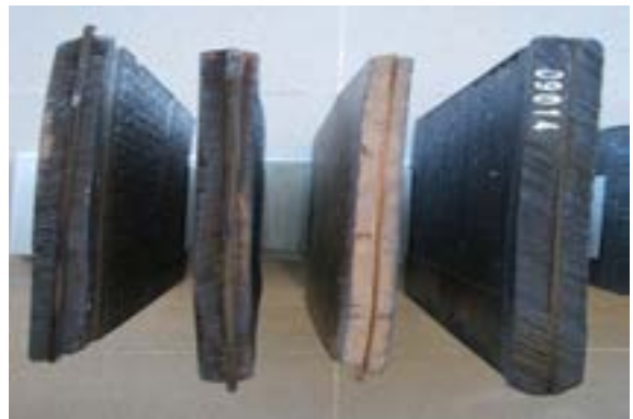
Mộc bản không có thanh nôm bị nứt nhiều hơn so với tấm có thanh tre nôm
