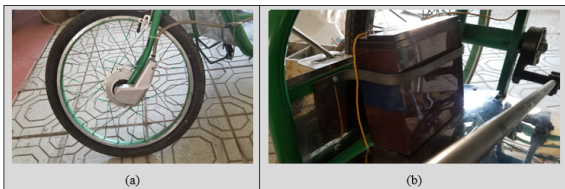
Hình 6: Lắp đặt moay ơ điện (a) và ốc quy (b)
