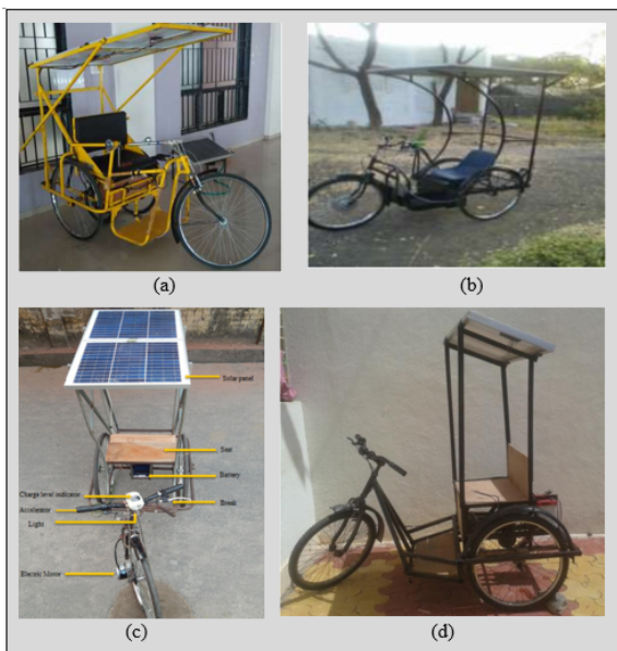
Hình 3: Một số mẫu xe điện xe ba bánh năng lượng mặt trời dùng cho người khuyết tật
